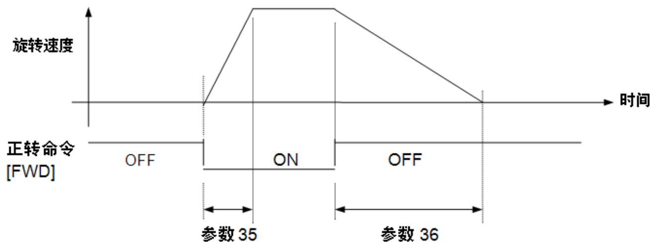
当上位控制装置输出模拟量速度命令电压、伺服放大器的分频输出以反馈形式进行位置控制时，请将加速时间及减速时间设定为 0.000 秒。
