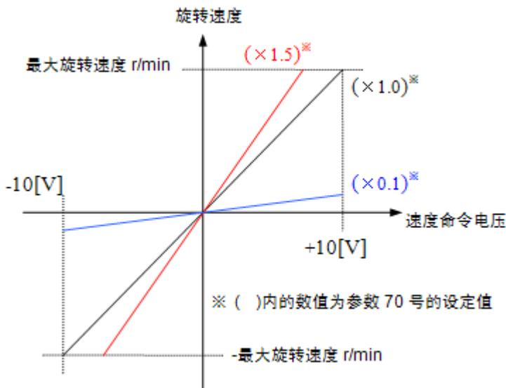
注 1) 由于伺服放大器及伺服电机各自的特性偏差, 电机的实际旋转速度存在±10[V]/±最大旋转速度±1%[r/min]的公差。
