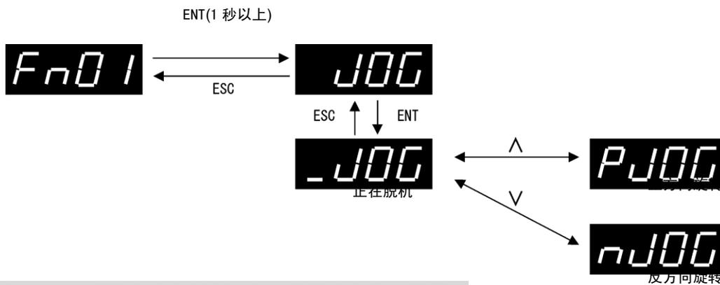
按下V和^键期间电机旋转，松开按键电机停止旋转。
