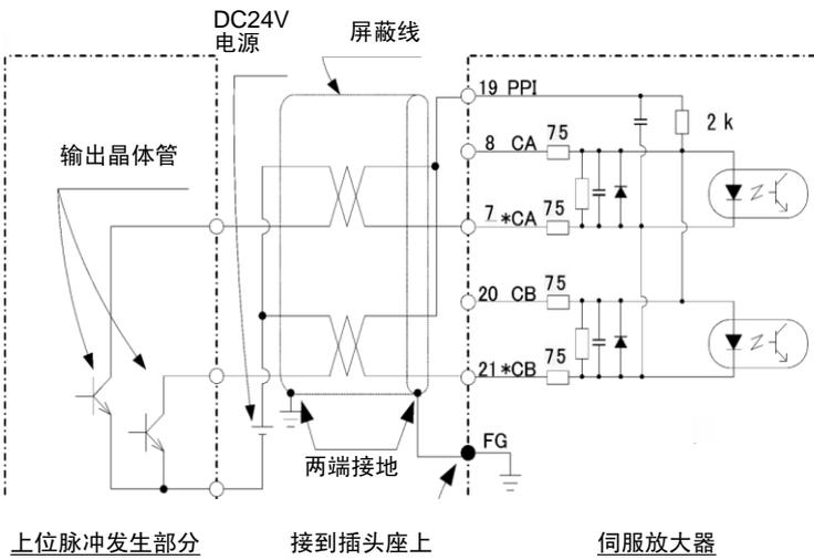
DC24V 电源: 电源电压范围应在  $DC24 \pm 5\%$  以内。
