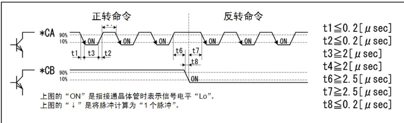
■正转脉冲/反转脉冲(参数 03 的设定值: 1)
