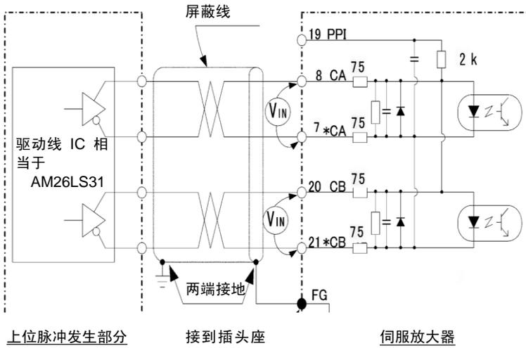
$V_{in}$ : CA-\*CA(CB-\*CB)间的电压振幅应在 2.8V~3.7V 内。
