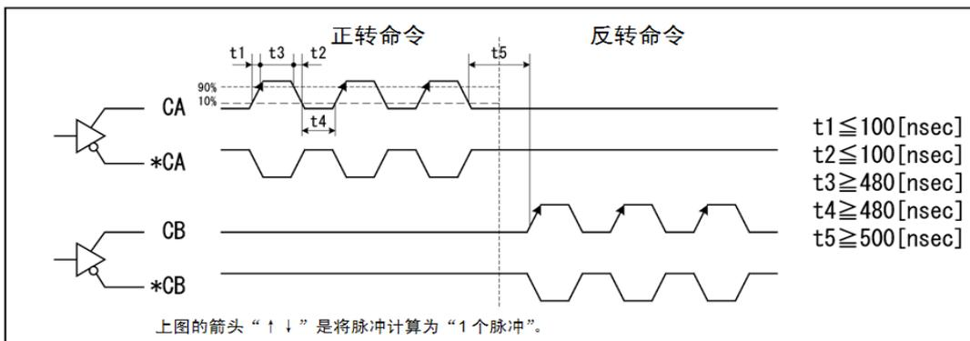
输出脉冲的相位切换选择伺服电机逆时针旋转 CCW(逆时针)时的相位。
