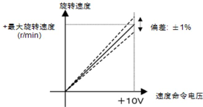
2) 模拟量速度命令输入电压的分解能力
