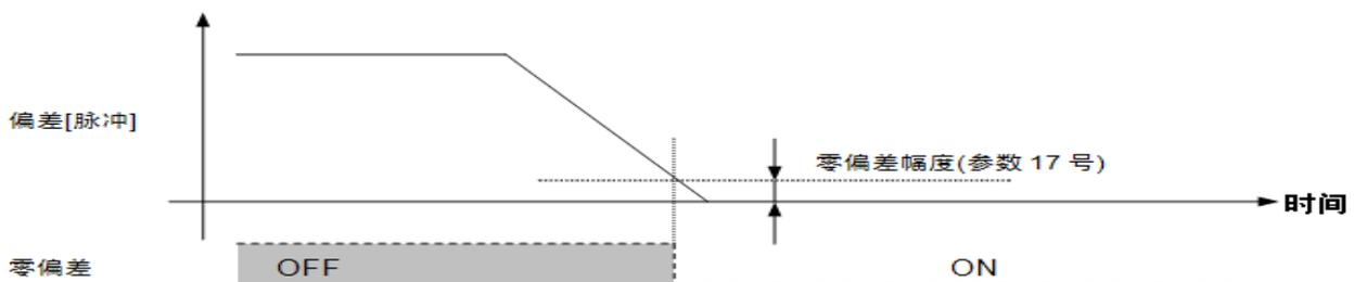
零偏差信号与零速度信号两者在定位结束否的判定(参数 20 号)期间如果连续接通, 则定位完成信号接通。
