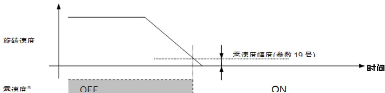
零偏差信号(参数 13 号)与零速度信号(参数 15 号)两者在定位结束否的判定(参数 16 号)期间如果连续接通, 则定位
