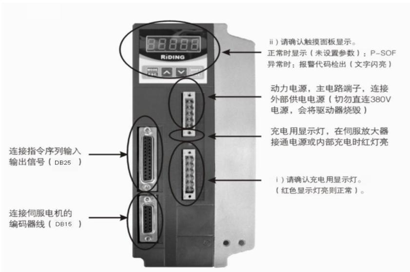
※报警检出时，请切断电源，确认配线
