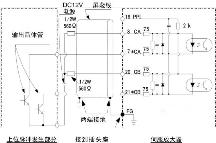
DC12V 电源: 电源电压范围应在  $DC12 \pm 5\%$  以内。
