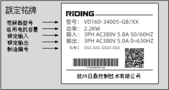
图 1-1：VD160 变频器铭牌示意图
